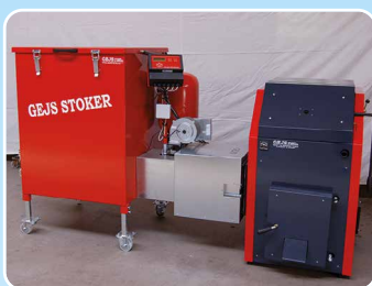
Model 6 + 400 liter magasin bestående af 100 mm snegl, 7-25 kW (max 30 kW), omrører type kædetræk med 2 disk og stor gear.
