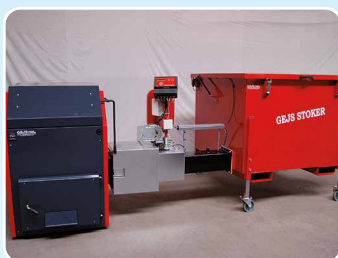
Model 3A-50 + 1250 liter magasin bestående af 130 mm snegl, 12-53 kW (max 70 kW), omrører type disk udmader i bund med gear.
