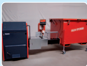
Model 3A-50 + 1250 liter magasin bestående af 130 mm snegl, 12-53 kW (max 70 kW), omrører type disk udmader i bund med gear.
