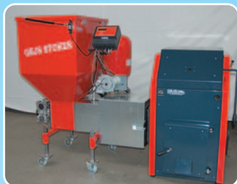
Model 6 + 250 liter magasin bestående af 100 mm snegl, 7-25 kW, uden omrører .
